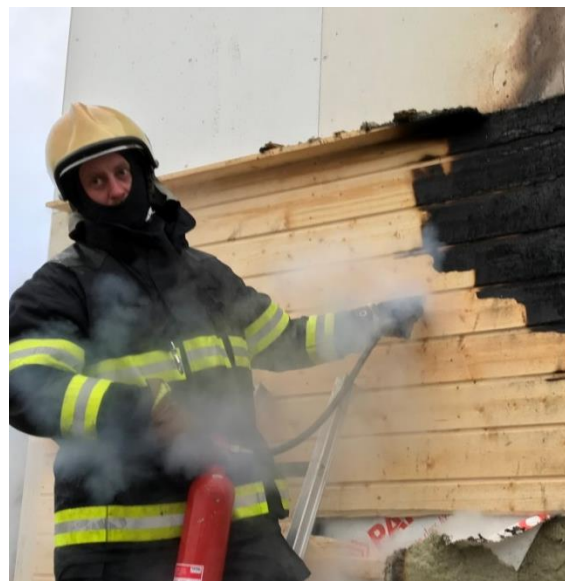
Joonis 32. Kustutamine süsihappegaasiga
