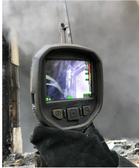
Joonis 28. Tulekollete leidmine termokaameraga fassaadi tuulutusvahes või isolatsiooni taga ja kustutamine veega
