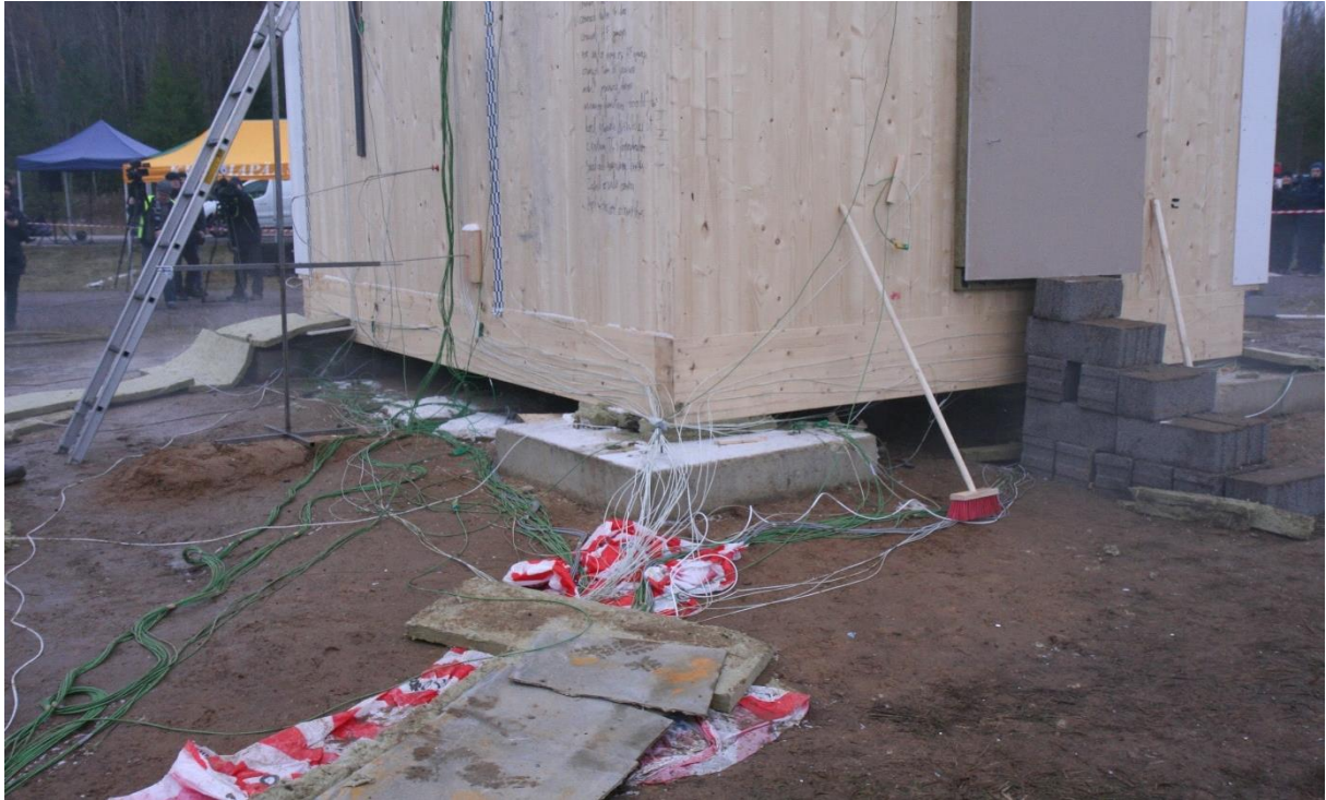
Joonis 17. Mõõteseadmete juhtmed katsehoone ümber
