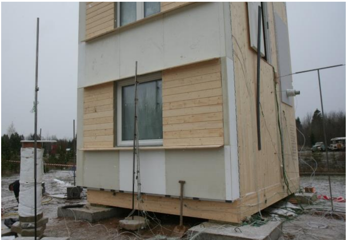
Joonis 18. Mõõteseadmed ja juhtmestik katsehoone ümber
