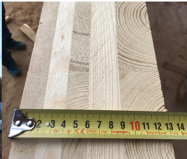
Joonis 9. CLT läbilõige erinevate kihipaksustega
