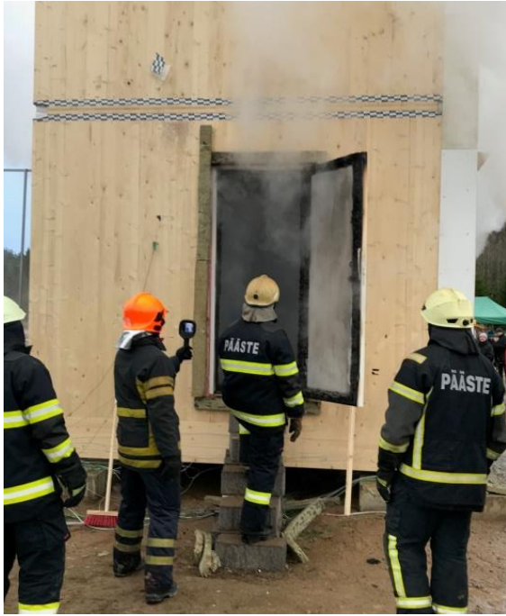
Joonis 27. Tulekollete otsimine termokaameraga ning kustutamine veega
